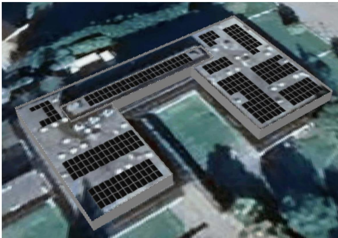
Slika 3: Situacija umestitve sončnih panelov na objekt
